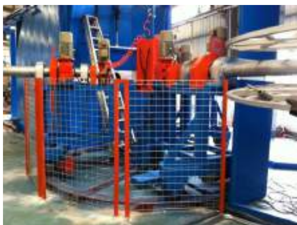
Рис. 4. Комплекс ротационного литья Jingsan JC-006 произведено фирмой Anhui, China (Mainland), ориентировочная стоимость 50 000 – 100 000 долларов США. Габаритные размеры (17.5×11.5×5.5) м
