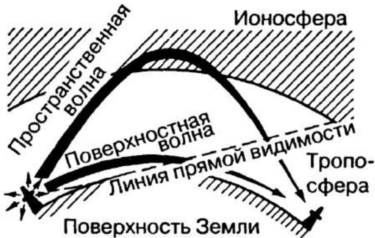
Рисунок 1 – особенности распространение радиосигнала КВ-диапазона
