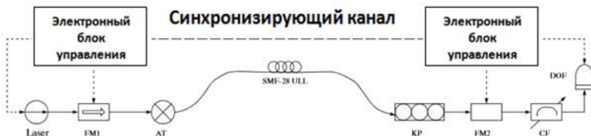
Рисунок 7. Схема системы квантовой криптографии, основанной на применении поднесущих частот
