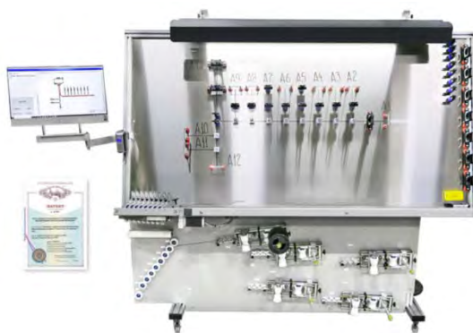
Рисунок 2. Интерактивный плаз с автоматической обрезкой провода
