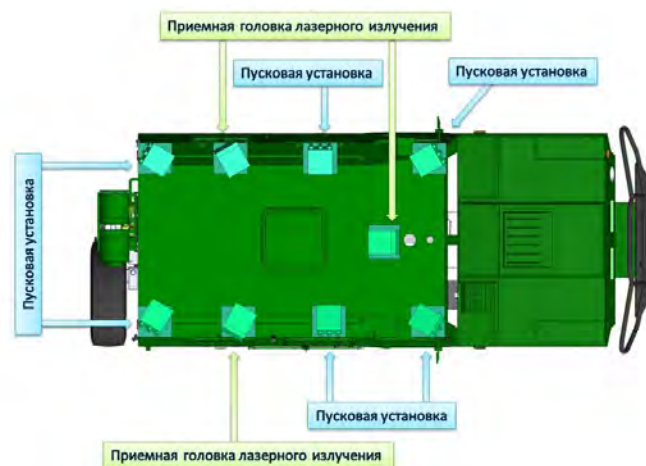
Рисунок 9. Пример размещения пусковых установок и приемных головок лазерного излучения ПКОРИ на автомобиле
