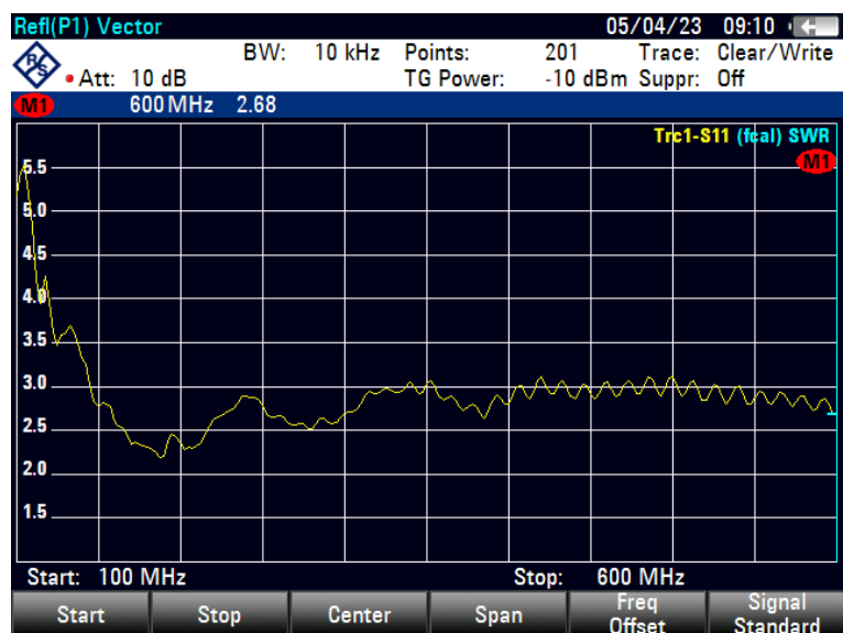
Рисунок 5. График значений КСВ в диапазоне частот 100...600 МГц: a – скелетная; б – однородная
