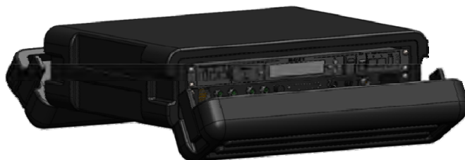
Рисунок 7. Пример размещения оборудования ВАРМ в кейсе-контейнере с рэковой стойкой
